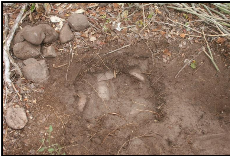
Figura 24: PT. 111. Prospecção interrompida, solo litólico, presença de sedimento com camada superficial orgânica, raízes pequenas e muitos blocos rochosos.
